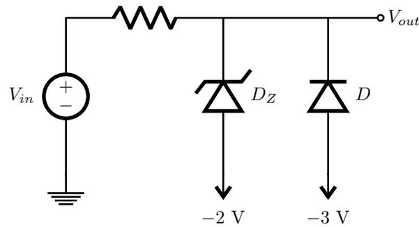
**Fig.7** - A voltage limiter using zener diodes.
