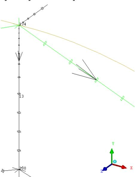
Figure 98: Edge Parameter Bunching
