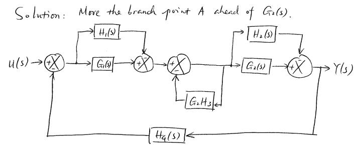
$$U(s) \rightarrow \underbrace{(G_1 - H_1)(G_2 - H_2)}_{1 + G_2 H_3} \rightarrow Y(s)$$
