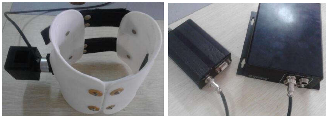
(a) 多维力传感器安装
