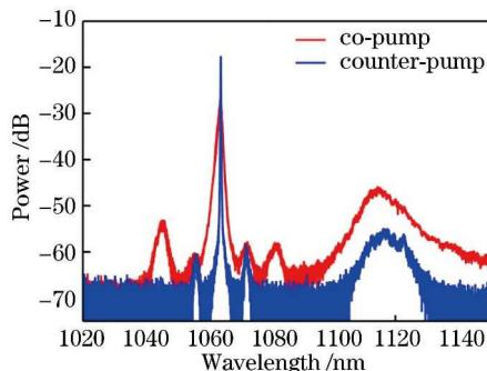
图 3 输出功率为 2 kW 时正向和反向抽运激光器的光谱
