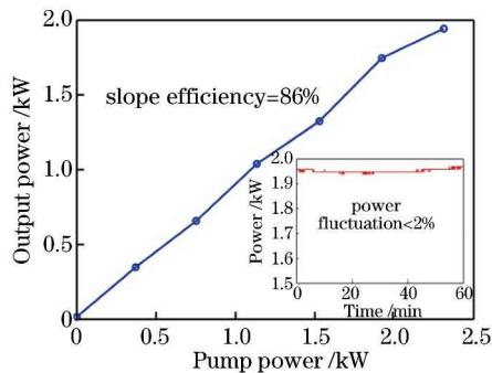
图 4 反向抽运激光器激光放大功率与抽运功率的关系
