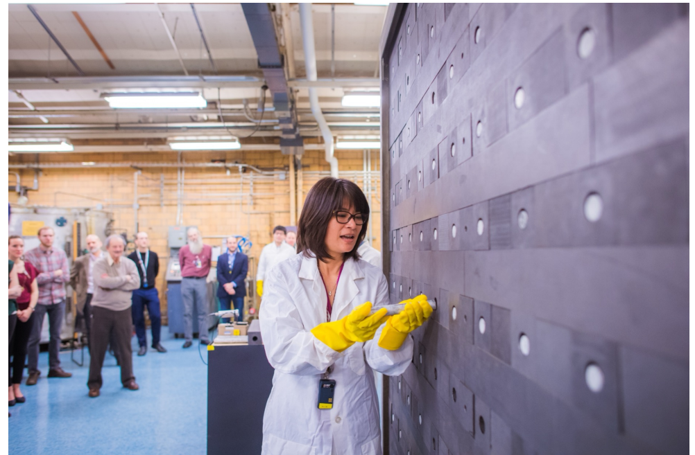
Inserting a Uranium fuel rod into the MIT Graphite Pile
