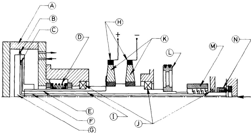
Fig. 1. Schematic view of the rotating system. A : pressure chamber ; B : liquid film ; C : CHF heater ; D : seal ; E : CHF power line ; F : stagnation heater electric cables and sensor wires ; G : rotating disc ; H : carbon brushes ; I : shaft ; J : bearings ; K : copper rings ; L : pulley ; M : slip-ring assembly ; N : inlet seal.
