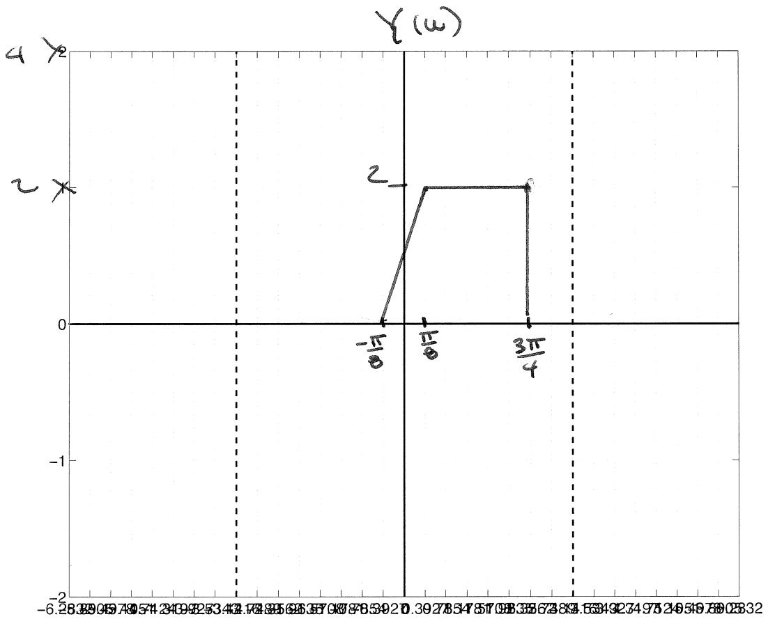
$$\frac{1}{2} \{ y(n) + y^*(n) \} \xrightarrow{\text{DTFT}} \frac{1}{2} Y(\omega) + \frac{1}{2} Y^*(-\omega)$$
